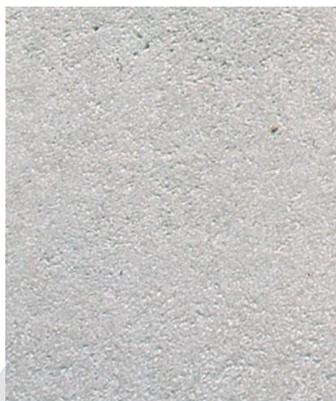
**Exterior:** Se puede revestir después de un tiempo de secado suficiente. En condiciones climáticas menos favorables, se debe dejar un tiempo de secado significativamente más prolongado. El uso de una imprimación adicional con CapaGrund Universal reduce el riesgo de eflorescencias, de modo que después de un tiempo de secado de 7 días se pueden revestir los morteros del grupo de yeso P Ic, P II o P III (cal, cal-cemento, cemento).
